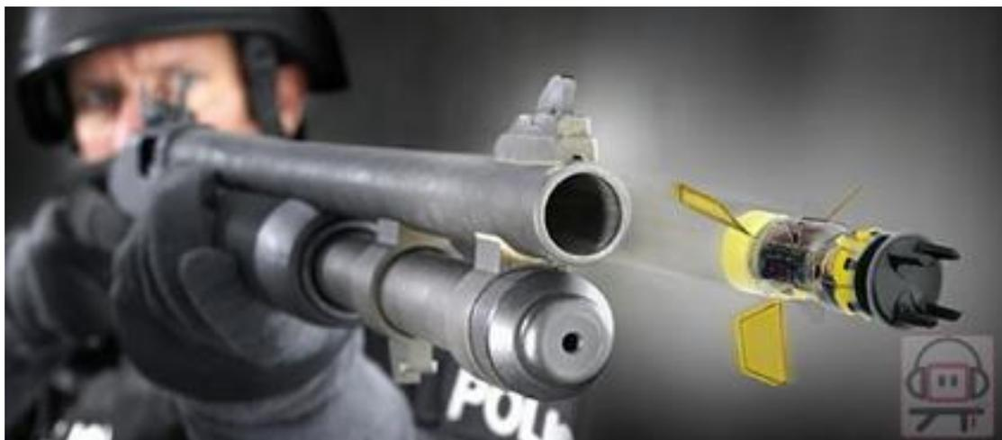
Avec un fusil à pompe, la portée devient bien plus importante ! Le fonctionnement du Taser XREP (eXtended Range Electronic Projectile = projectile électronique à portée étendue) est donc assez différent ... car il ne s'agit plus d'une arme spécifique mais d'une arme conventionnelle dont on change la cartouche pour une "électrique".
